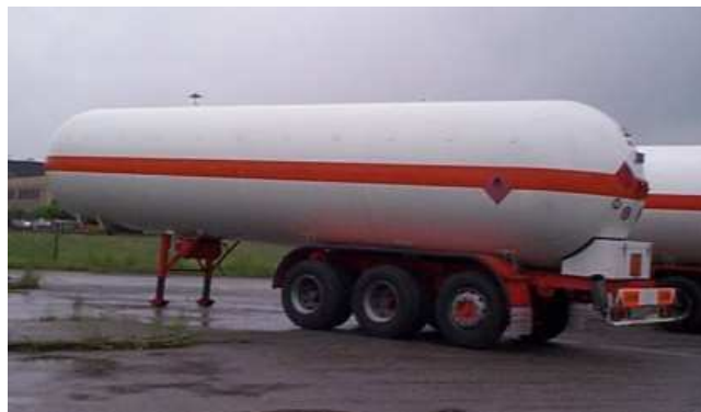
Figura 5.11: sezione cilindrica con calotte semisferiche
